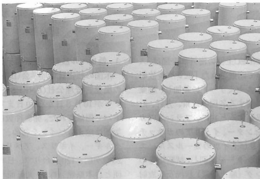
写真：THTR-300用球状燃料を収納しているキャスク
